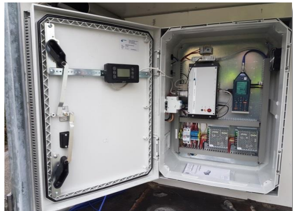
Abb. 4: Messgerät und Modemeinheit:
