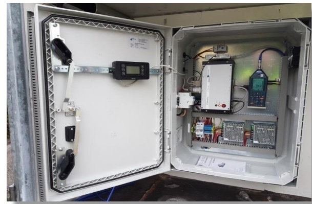
Abb. 4: Messgerät und Modemeinheit:
