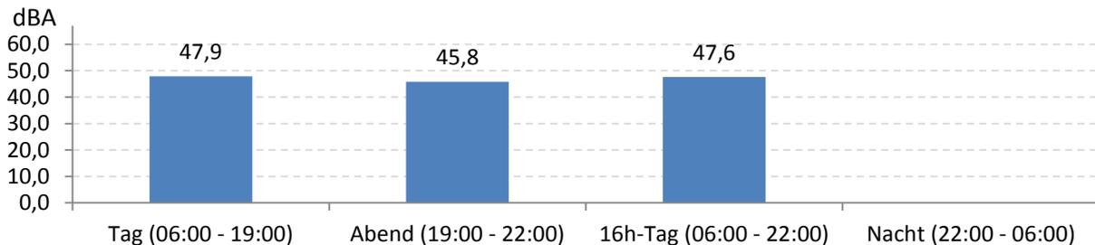
Abb. 9: LEQ bei Pistenbetriebsrichtung "östliche Winde" 305 Stunden im Messzeitraum
