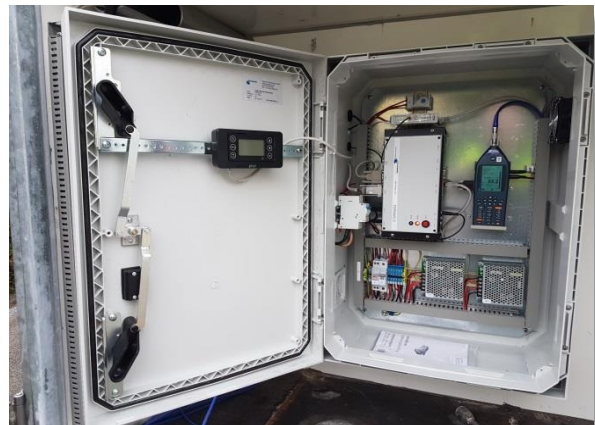
Abb. 4: Messgerät und Modemeinheit:
