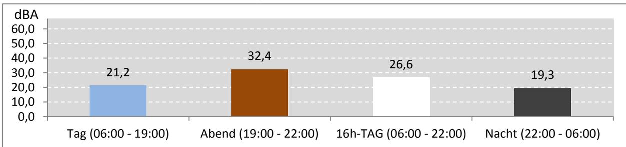
Abb. 9: LEQ bei Pistenbetriebsrichtung "östliche Winde" 101 Stunden im Messzeitraum
