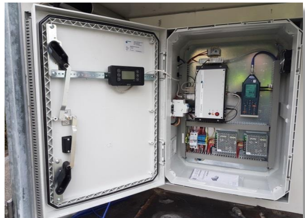
Abb. 4: Messgerät und Modemeinheit:
